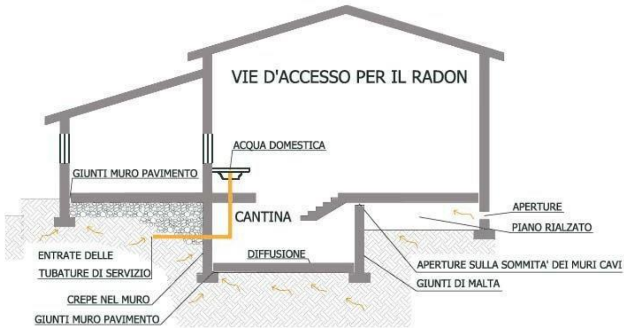
Figura 5: vie d'accesso per il radon
