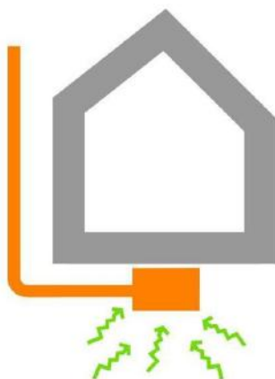
Figura 13: depressione del sottosuolo tramite pozzetto.
