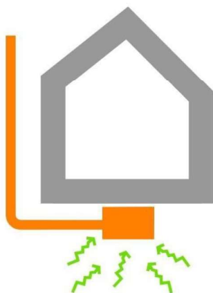
Figura 13: depressione del sottosuolo tramite pozzetto.
