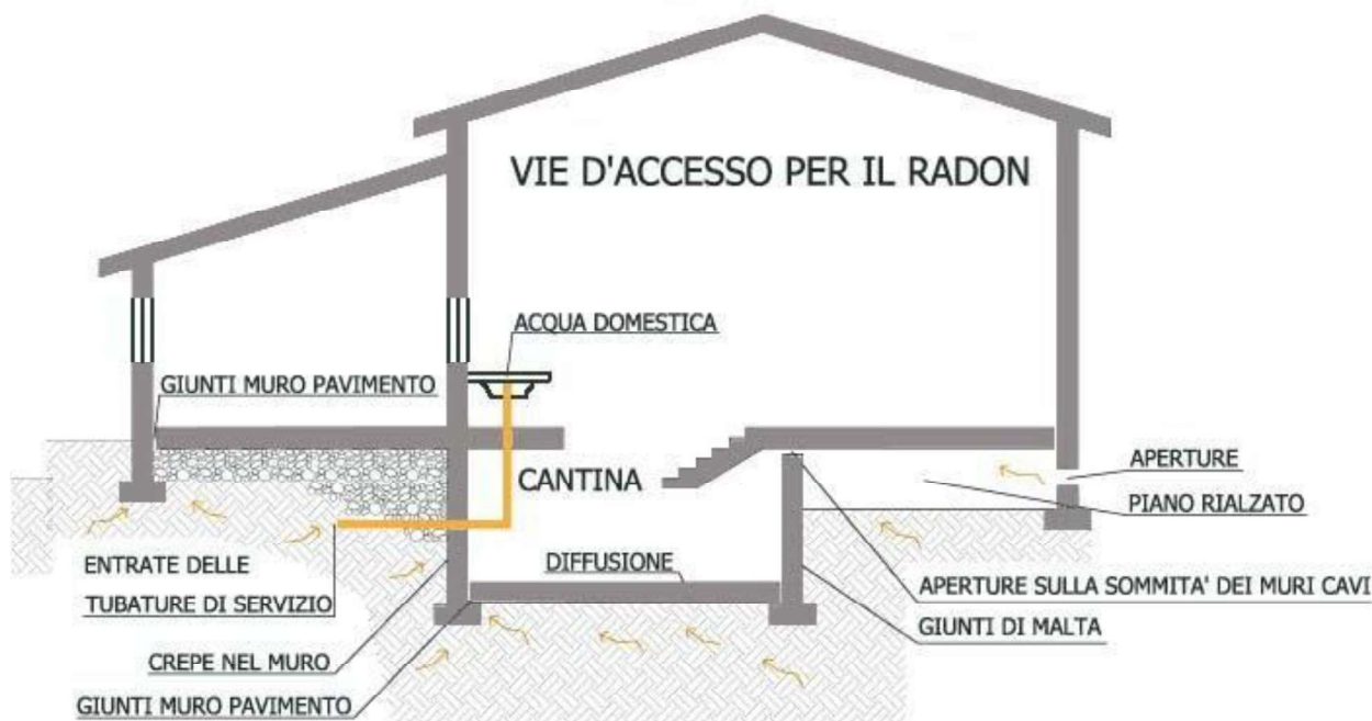
Figura 5: vie d'accesso per il radon
